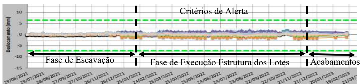
Figura 17 – Deslocamentos horizontais yy dos alvos nas paredes da galeria do ML (mm).
