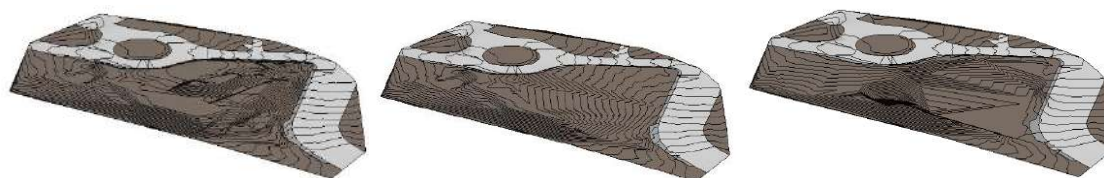
Figura 2 – Existente (esquerda), Remodelação terrenos (centro) e Taludes provisórios (direita)
