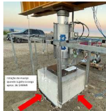
Figura 14 - Rotação do maciço de encabeçamento da microestaca ensaiada à compressão.
