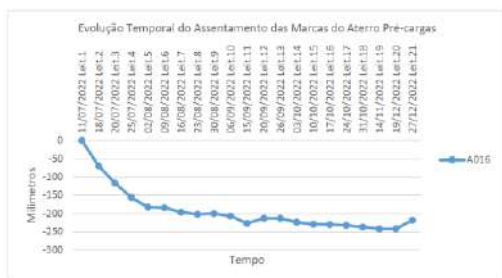
Figura 3 - Gráfico tempo-deformação. Instrumentação da zona do aterro de pré-carga.
