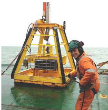
Figura 5 – Equipamento para execução de ensaio CPT no solo marítimo
