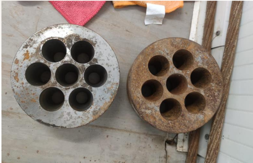
Bloco de ancoragem das cordoalhas
