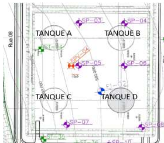
Figura 2. Planta de sondagens locais
