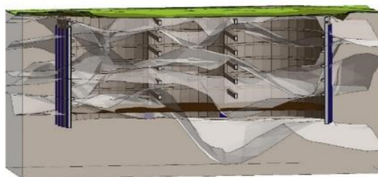
Figura 7. Interfaces entre unidades geotécnicas realizadas no GEO5 e exportadas para o Revit em formato IFC.
